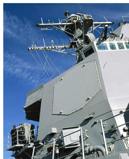
3、查 SOLAS 公约 2000 修正案第 V 章第 19.2.2.3 要求：所有 300 总吨及以上的船舶和不论尺度大小的客船，应设有 1 台 9GHz 雷达，用于确定和显示雷达应答器、其他水上船艇、障碍物、浮标、海岸线和航标的距离和方位，供以助航和避碰。
